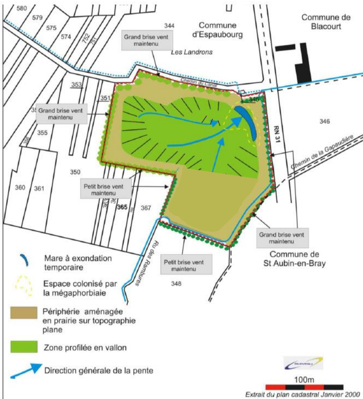
Figure 5 : Etat final de l'aménagement après exploitation (Source : Etude d'impact société GUINTOLI dossier d'autorisation 2009)
