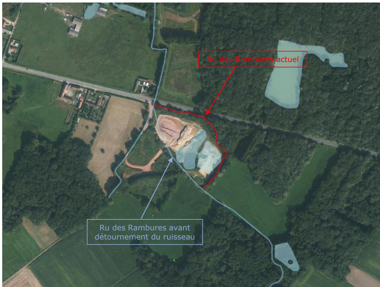
Figure 12 : Détournement du Ru des Rambures Source : Géoportail - Arca2e
